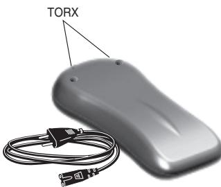
El Descodificador **DTP-300** se instala en cada una de las habitaciones del hotel, cerca del receptor de televisión. La caja deberá abrirse para acceder a los microinterruptores internos de direccionamiento, así como para proceder a su fijación mural y a la conexión de los cables SCART y de alimentación red (ver a la vuelta). Soltar los tornillos TORX.
