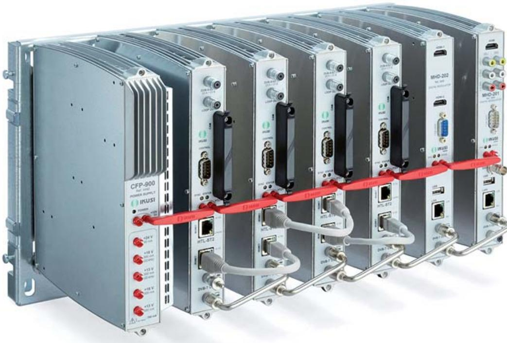
Modules ClassA avec bus IKUNET de communication qui permettent une gestion et administration centralisée de la station de tête.
